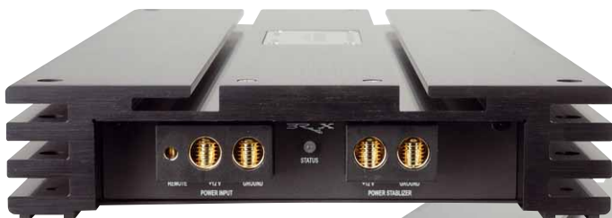
Puristisch: An der GX gibt es nichts einzustellen. Dafür wertige Buchsen und Terminals, unter anderem einen speziellen Anschluss für Powercaps, der direkt zu den Kondis führt
