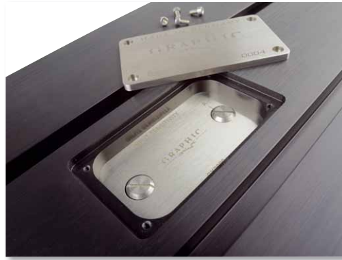
Unter dem vorderen Chromtöpfchen sitzt die für Brax typische Speicherdrossel. Rechts daneben ist das kleine Treibernetzteil. Die einzigen Bedienelemente sind die kanalgetrennten Pegelsteller, die unter dem Deckel versteckt sind
