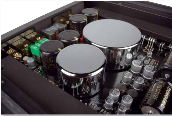
Unter dem vorderen Chromtöpfchen sitzt die für Brax typische Speicherdrossel. Rechts daneben ist das kleine Treibernetzteil. Die einzigen Bedienelemente sind die kanalgetrennten Pegelsteller, die unter dem Deckel versteckt sind
