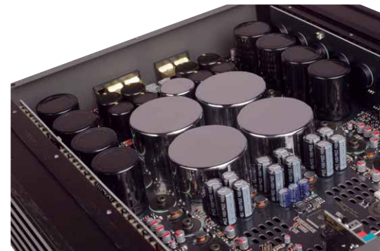
Speziell produzierte Pufferkondensatoren, handgewickelte Transistoren und die Brax-typischen Speicherdrosseln
