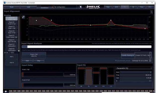
Im ISA können beliebige Eingänge und deren Summen gemessen werden. EQ (mit Allpass) und Laufzeit korrigieren das eingehende Signal
