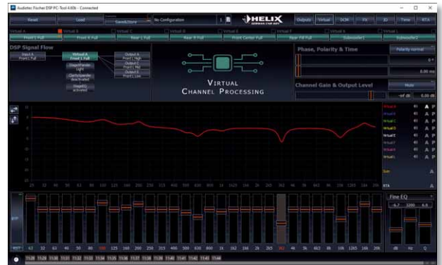
Das Setup der virtuellen Kanäle entspricht dem der Ausgangskanäle, nur ohne Frequenzweichen. Der virtuelle Front-EQ und das FX-Frontprocessing wirken dann auf alle Ausgangskanäle, die von dort geroutet wurden
