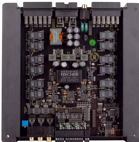
Die V Twelve ist im Prinzip eine um vier Kanäle verlängerte V Eight, dennoch verfügt sie über ein eigenes, platzsparendes Layout
