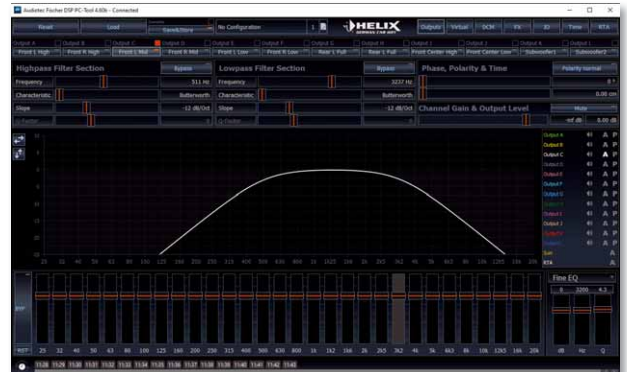
Wie gewohnt steht bei allen Ausgangskanälen ein umfangreiches Arsenal an Frequenzweichen, Equalizern und Laufzeitkorrektur bereit
