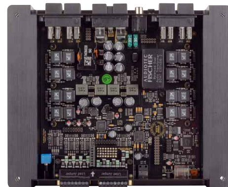
Die V Twelve ist im Prinzip eine um vier Kanäle verlängerte V Eight, dennoch verfügt sie über ein eigenes, platzsparendes Layout
