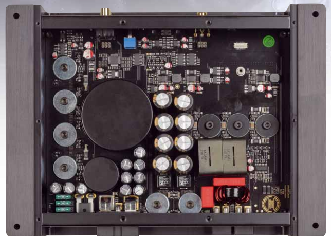
Die Leistungstransistoren befinden sich unter der Platine, das Netzteil enthält eine Speicherdrossel
