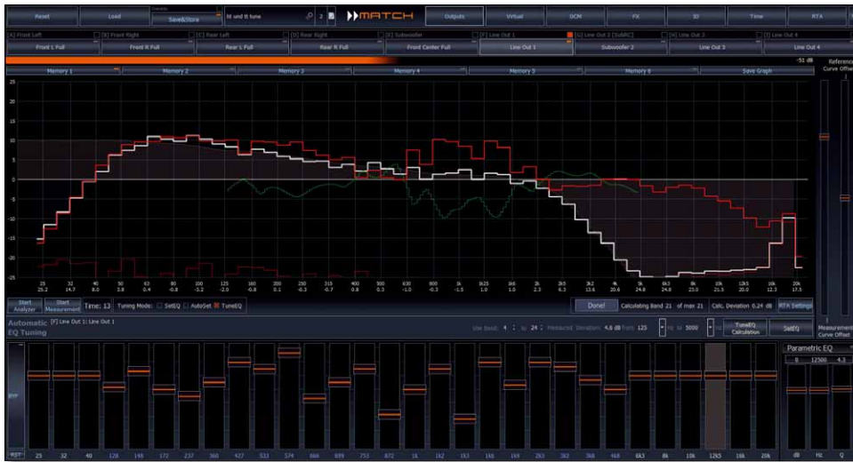
RTA-Messung eines Tiefmitteltöners: Ursprungskurve (rot) und Ergebnis mit 24-dB-Trennung (weiß). In grün ist die Korrektur per TuneEQ zu sehen und unten sind die EQ-Bänder 4 – 24 eingestellt. Wir haben mit einer Genauigkeit von 1/6 Oktave und Standardglättung gemessen, es geht auf Wunsch feiner
