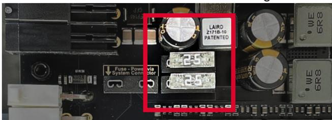
Stecken Sie anschließend eine der zuvor entfernten 25 A Sicherungen auf den Steckplatz „Fuse - Power via System-Connector“.
