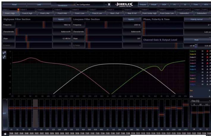
Im Output-Menü lassen sich Frequenzweichen und Equalizer für alle Ausgangskanäle einstellen
