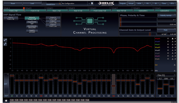
VCP- Routing Schritt 2: Jetzt werden die 8 virtuellen Kanäle auf die 12 Ausgänge geroutet, z.B. virtueller Frontkanal auf Hochtöner, Mitteltöner, Tieftöner und virtueller Centerkanal auf Centertieftöner und Centerhochtöner
