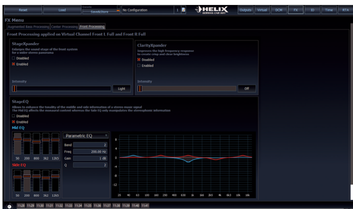
Zum Front-Processing gehört jetzt ein Mid/Side-EQ, mit dem Bühnenmitte und Bühnenränder getrennt geregelt werden können
