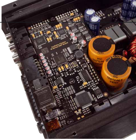
Die DSP-Platine der M FOUR DSP ersetzt die analoge Eingangsplatine der M FOUR
