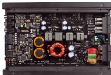
Bei der M ONE X (links) sorgen jede Menge Kupfer für das volle Kilowatt Leistung. Die M FOUR DSP arbeitet dagegen mit zwei kleinen Verstärker-ICs
