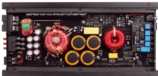
Bei der M ONE X (links) sorgen jede Menge Kupfer für das volle Kilowatt Leistung. Die M FOUR DSP arbeitet dagegen mit zwei kleinen Verstärker-ICs
