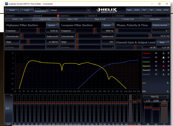
Im Hauptfenster werden Weichen und Equalizer eingestellt, zusätzlich gibt es einen Mute-Button und Schieber für Phase und Pegel
