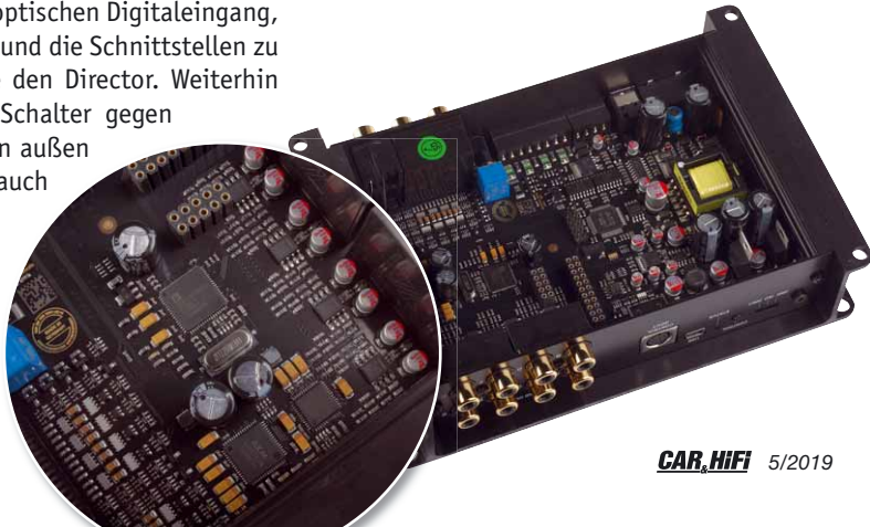
Der DSP.3 wurde mit allerfeinsten Komponenten aufgewertet. Beide Wandler sind jetzt 32-Bit-Typen
